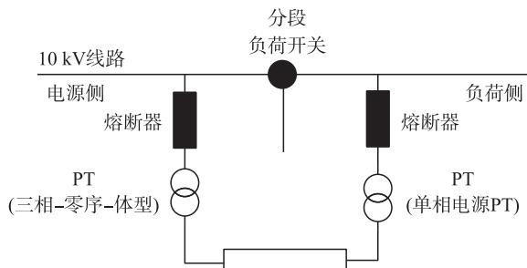
图1 电压柱上负荷开关结构图
