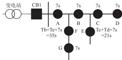
图 5 电压型柱上开关配置在主干线和分支线上
